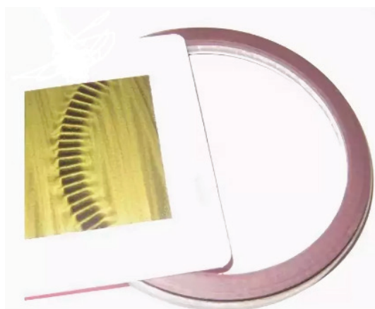
Рис. 2. Карта, заполненная металлической стружкой и маслом для проверки магнитного кольца ступичного подшипника типа HUB-1
