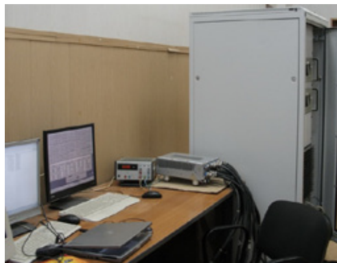
Рис. 4. СПМ для испытаний и настройки САУ ГТД
