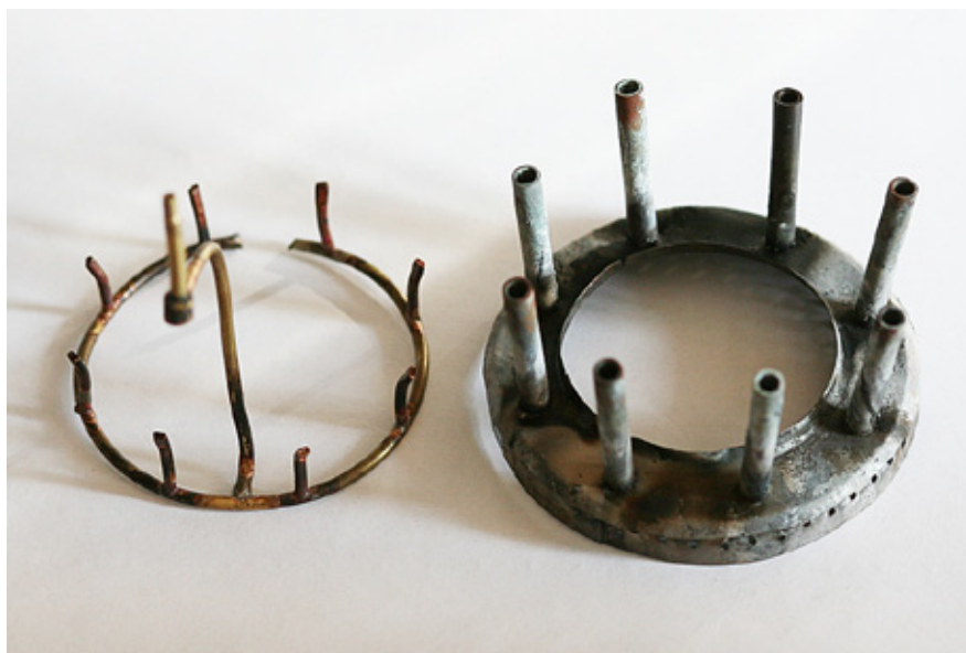
Рис. 2. Детали испарительной форсунки
