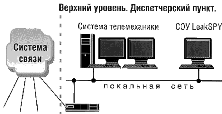
Рис. 1. Структурная схема системы мониторинга трубопровода с применением СОУ «LeakSPY»
