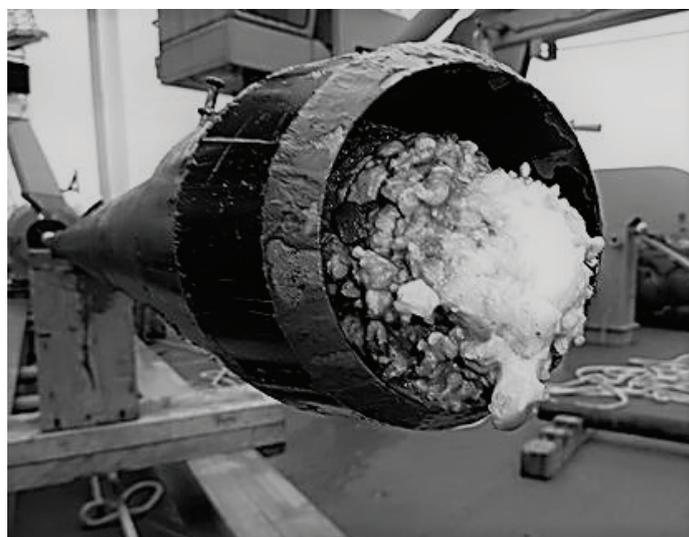
Рис. 1. Гидратообразование в буровой трубе
