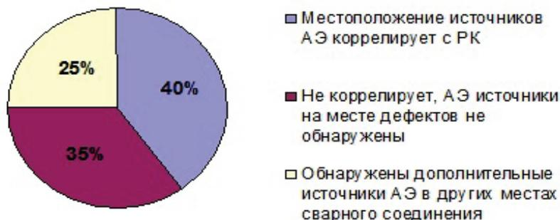
Рис. 4. Диаграмма корреляции местоположения обнаруженных источников АЭ контроля с дефектами сварных соединений по результатам радиографического метода контроля [8]
