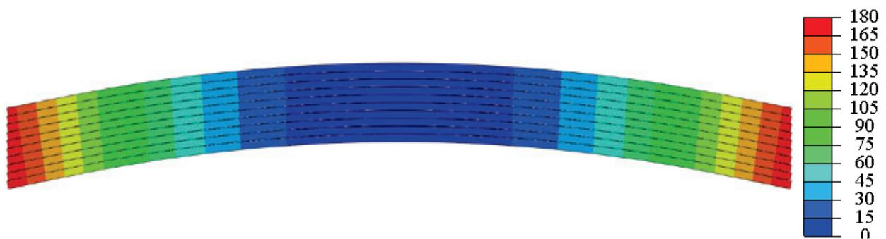
Рис. 4. Распределение модуля вектора перемещений, мм
