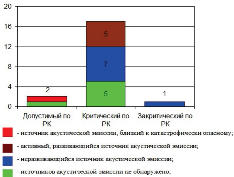
Рис. 3. Диаграмма результатов РК и АЭ контроля поперечных сварных соединений трубопровода [8]
