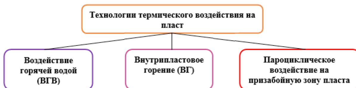
Рис. 1. Основные технологии термического воздействия на пласт
