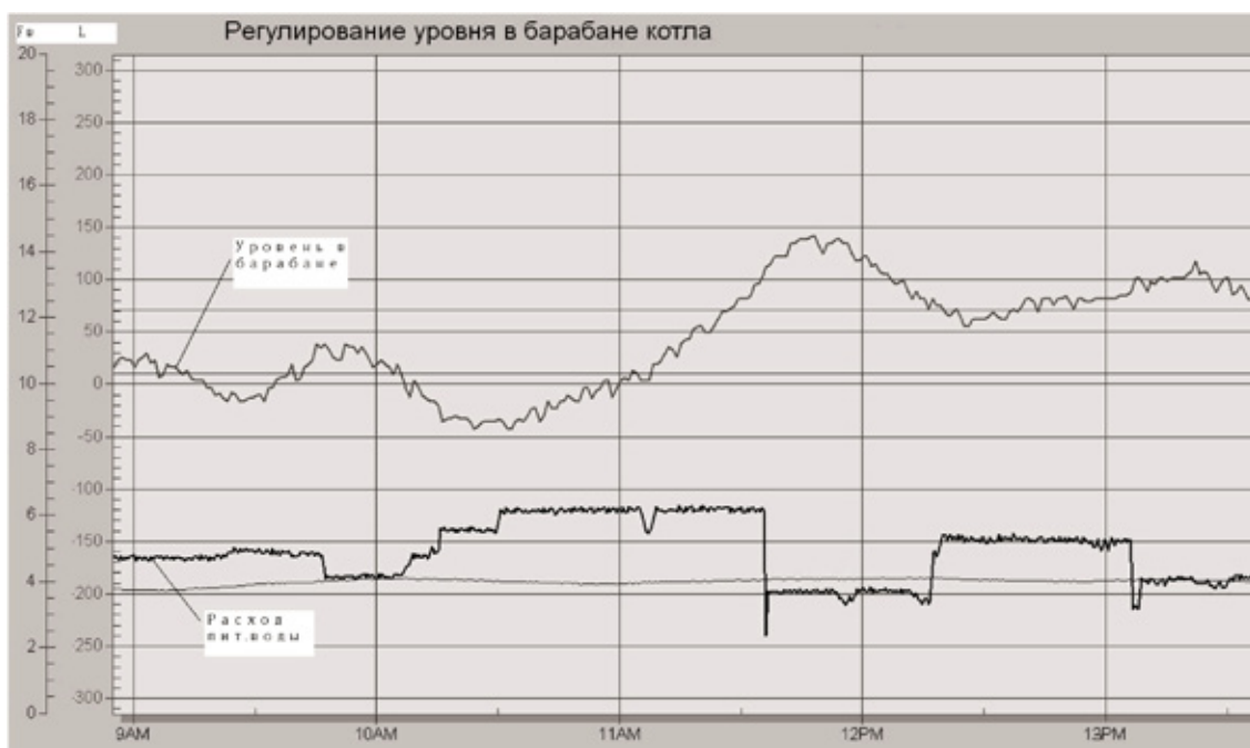
Рис. 2. График регулирования уровня в барабане КУ
