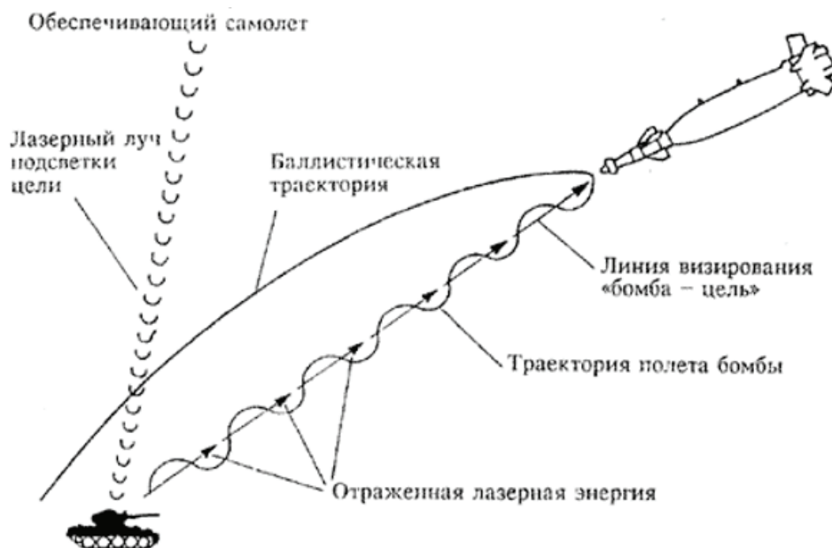
Рис. 1. Алгоритм работы системы лазерного наведения высокоточного оружия
