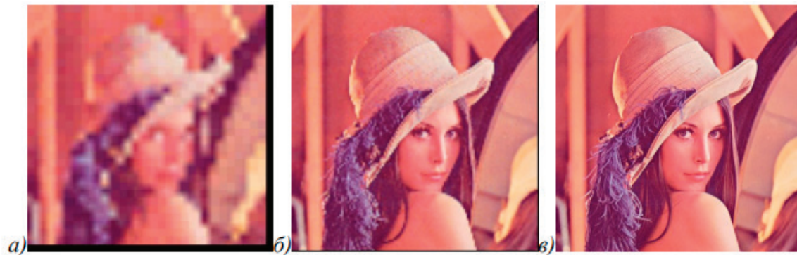
Рис. 2. Пример работы метода обеспечения доступности (рис. 2а — один сегмент исходного изображения после интерполяции; 2б — 16 из 256 сегментов исходного изображения после интерполяции, рис. 2в — исходное изображение)
