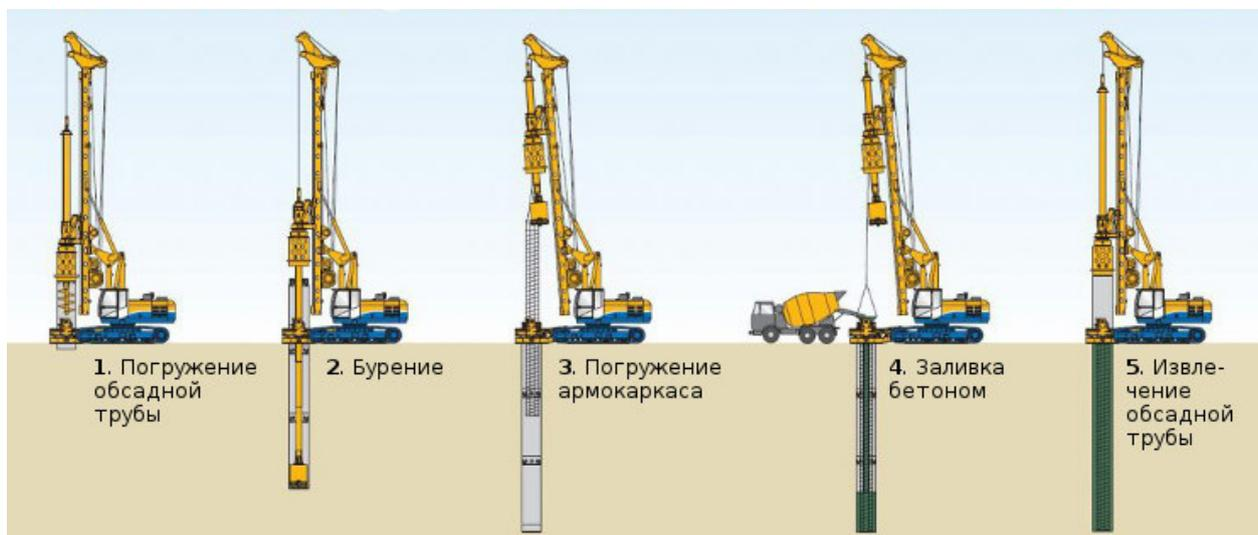
Рис. 3. Устройство буронабивных свай
