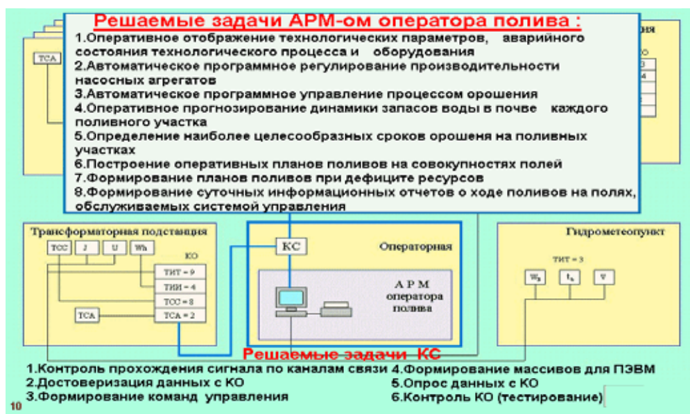
Рис. 2. Структурно-функциональная схема АСУ ТП орошения
