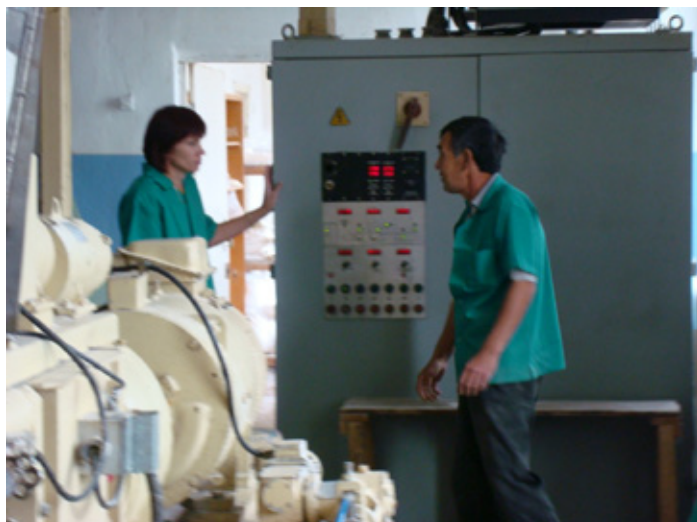
Рис. 2. Контрольно-измерительная система экструдера
