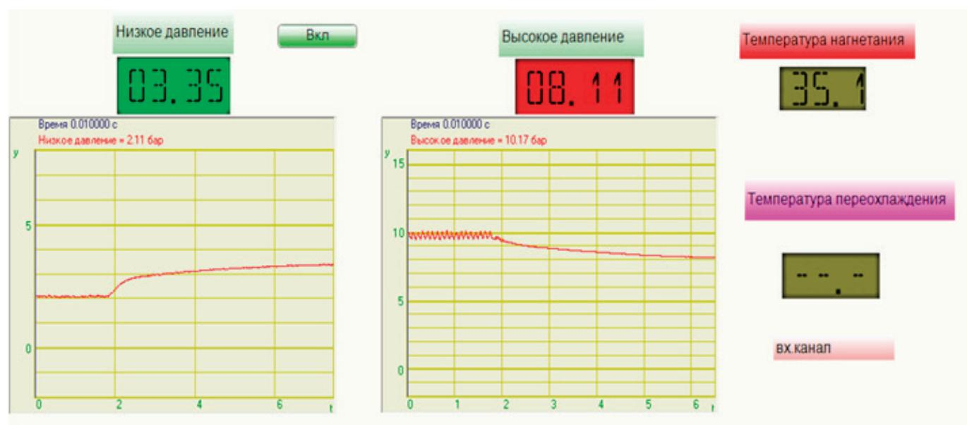
Рис. 3. Показания давлений на момент выключения установки при номинальном режиме
