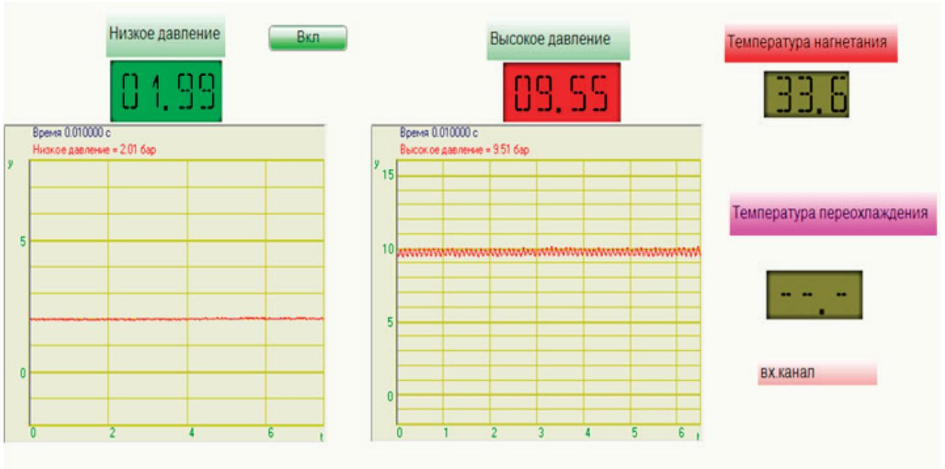
Рис. 4. Показания давлений на электродвигателе и на муфте компрессора кондиционера на оптимальном режиме
