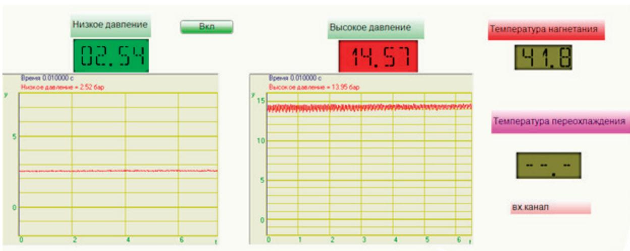
Рис. 3. Показания давлений на электродвигателе и на муфте компрессора кондиционера при недостаточной производительности конденсатора
