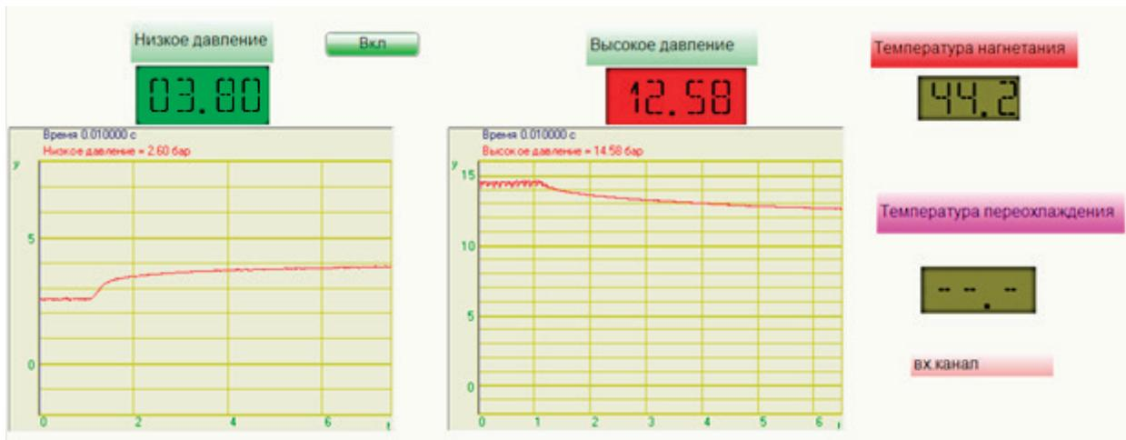
Рис. 2. Показания давлений на момент выключения установки при недостаточной производительности конденсатора
