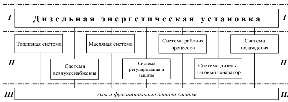
Рис. 1. Структурная блочно-функциональная схема декомпозиции дизельной энергетической установки
