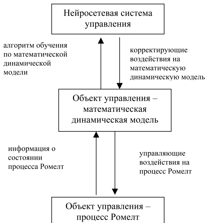
Рис. 5. Принципиальная схема функционирования нейросетевых систем управления процессом Ромелт
