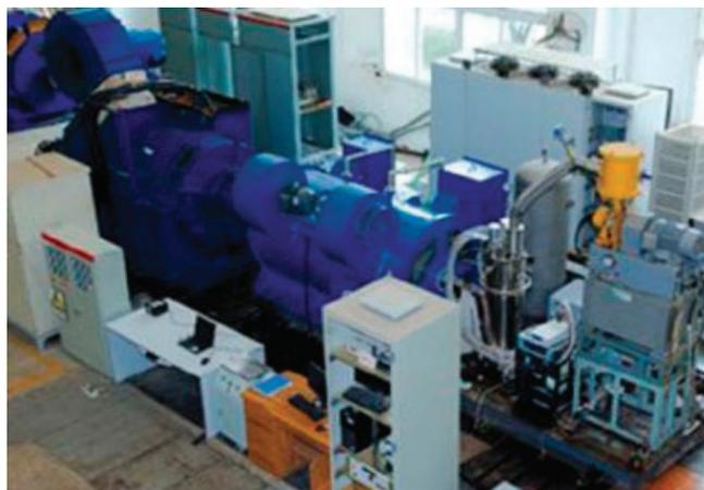
Рис. 2. Прототип судового ВТСП электродвигателя мощностью 1 МВт
