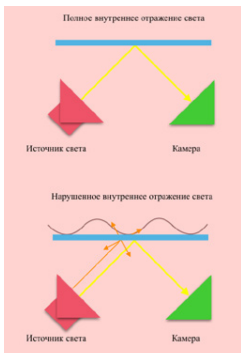
Рис. 2. Принцип работы FTIR-сканера: полное внутреннее отражение, нарушенное внутреннее отражение
