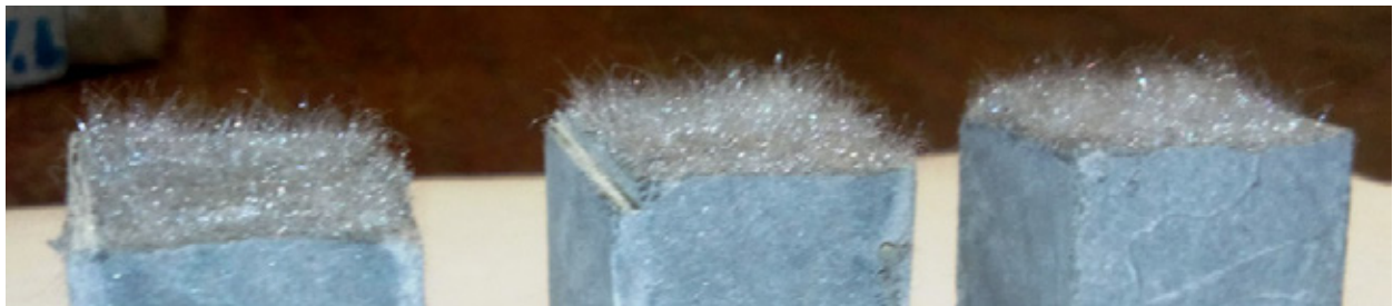
Рис. 2. Полипропиленовые волокна распределенные в матрице цементного камня
