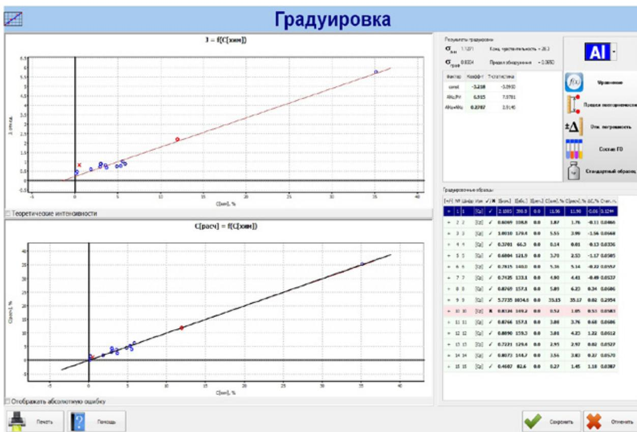
Рис. 1. Градуировочная зависимость для Al на методику без предварительной сушки ГСО/ОСО
