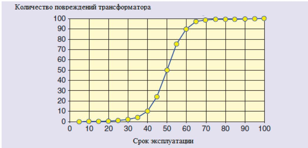
Рис. 1. Частота повреждений трансформатора как функция от срока эксплуатации [1]
