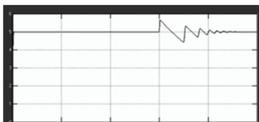
График выходного напряжения ПИД-регулятора при токе нагрузки от 1А до 0,1А
