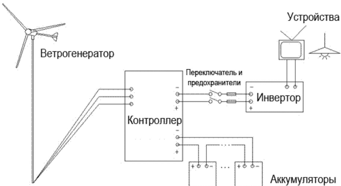
Рис. 2. Схема питания потребителей от ветрогенератора
