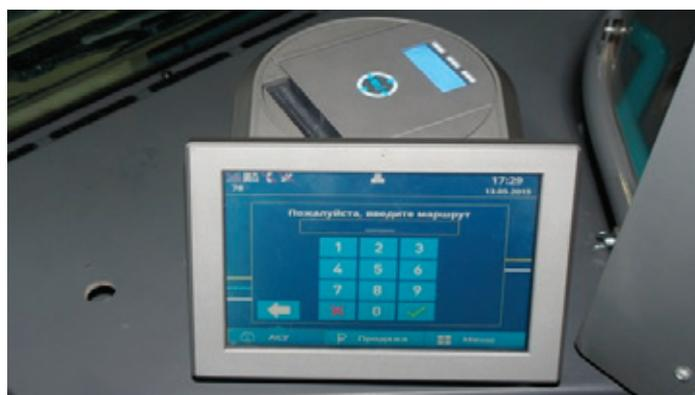
Рис. 4. Сенсорная панель водителя вместо привычных кнопок
