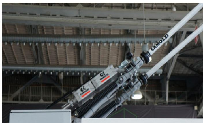
Рис. 3. Пневматический штангоуловитель итальянской фирмы «Camozzi»
