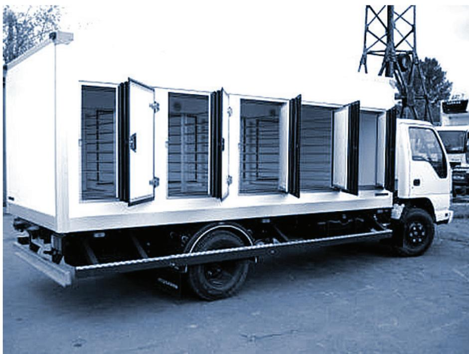
Рис. 1. Рефрижераторный кузов
