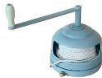
Рис. 1. Механический штангоуловитель
