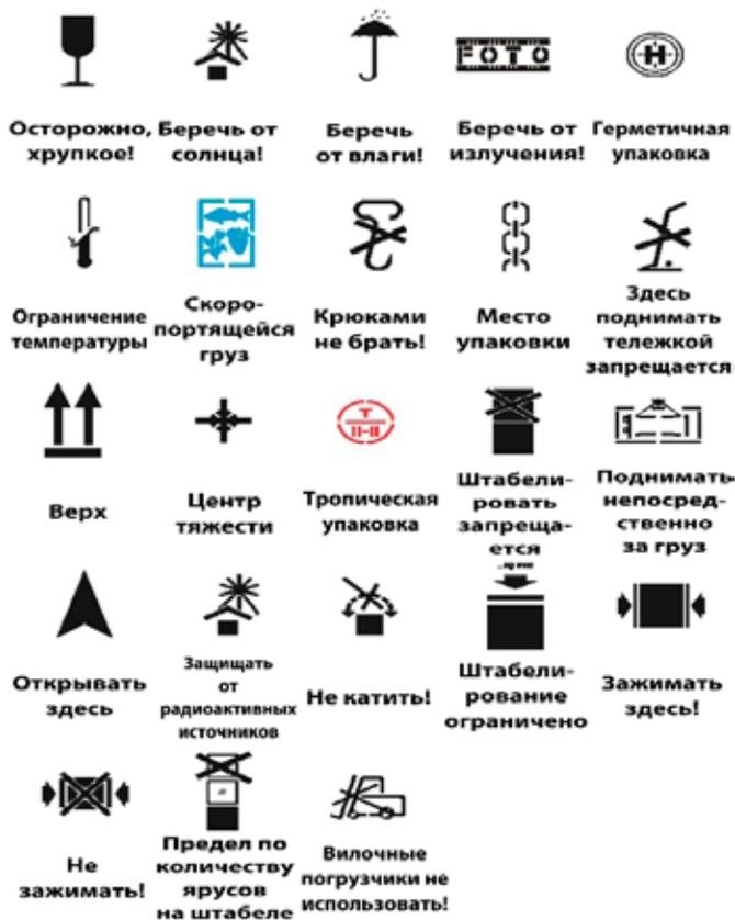
Рис. 2. Маркировка грузов
