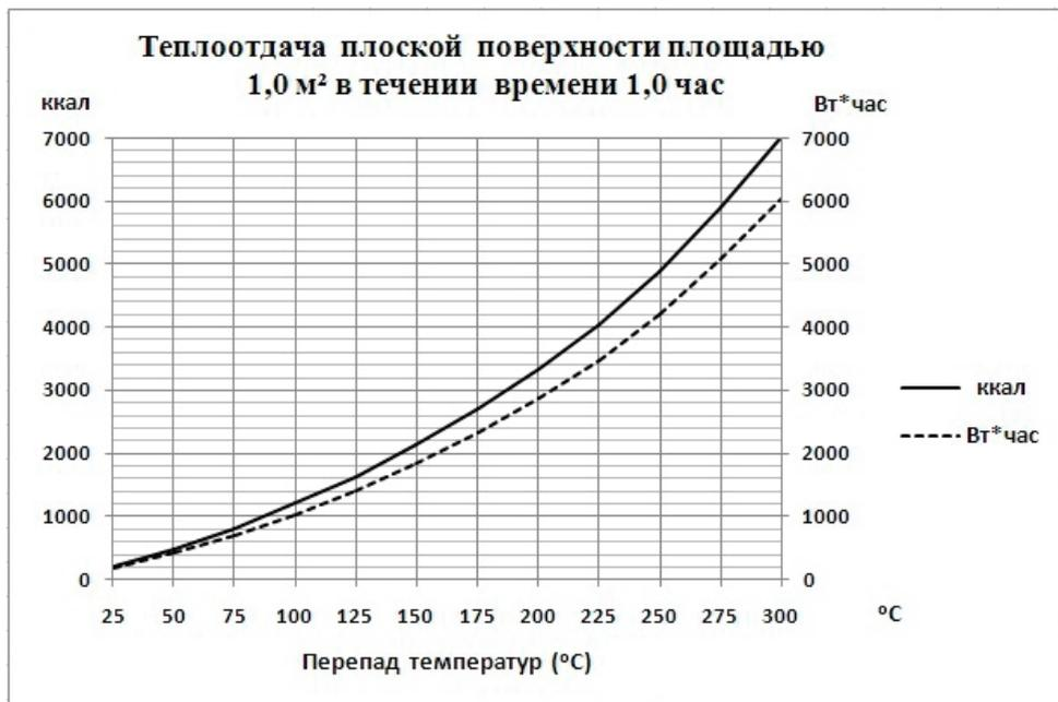
Рис. 4. Теплоотдача плоской поверхности
