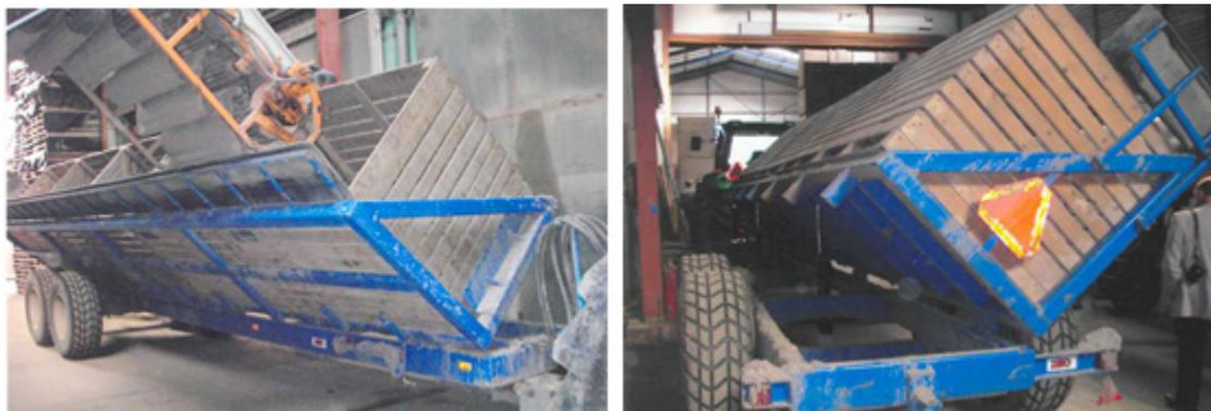
Рис. 2. Прицеп-контейнеровоз с загрузкой на боковую стенку контейнера (в рабочем положении)
