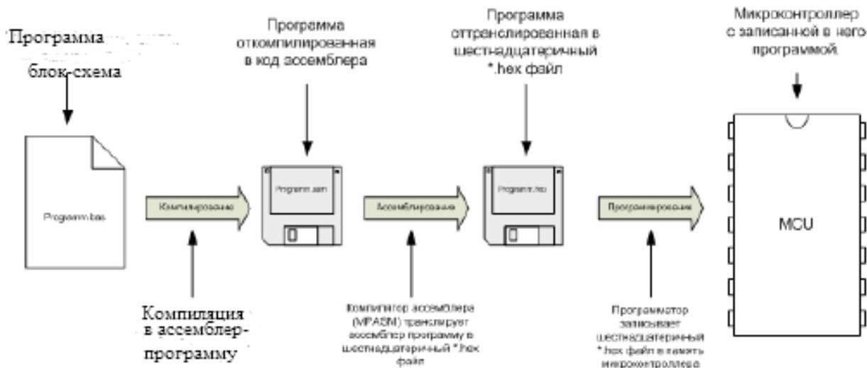
Рис. 1. Программирование микроконтроллера
