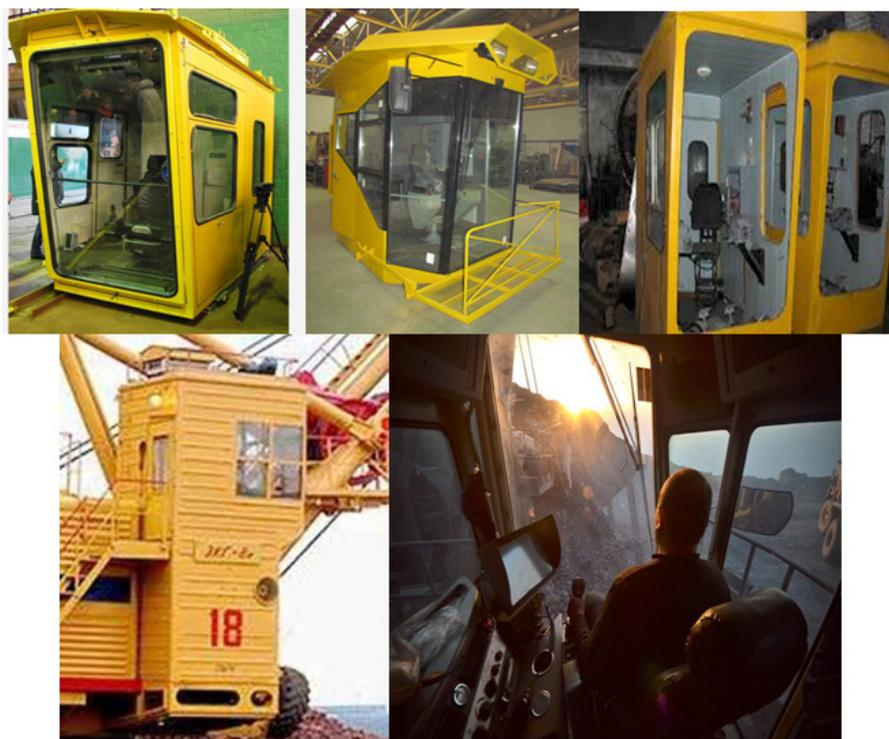
Рис. 2. Кабины машинистов экскаваторов
