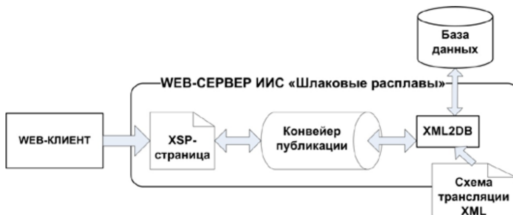
Рис. 3. Структура web-приложения ИИС «Шлаковые расплавы» версии 6.0
