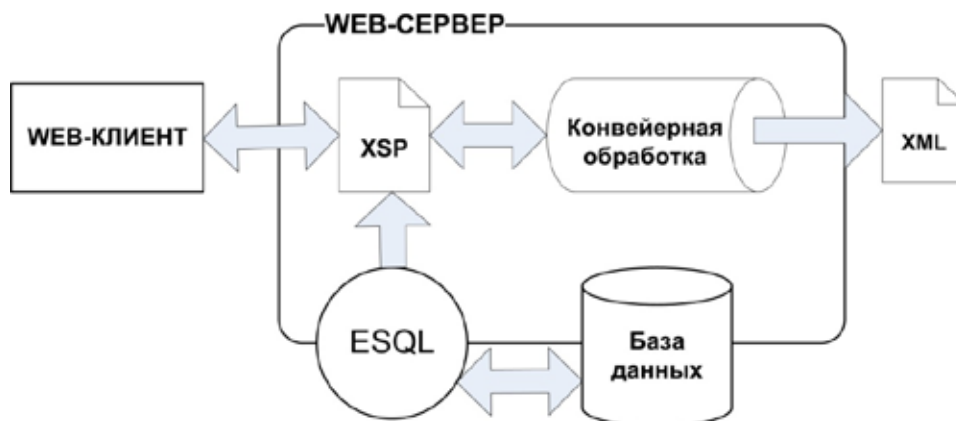
Рис. 5. Структура web-приложения ИИС «Шлаковые расплавы» с использованием библиотеки ESQL
